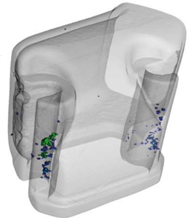
CT Scan eines Aluminiumgussteils Poren- und Lunkerdetektion
